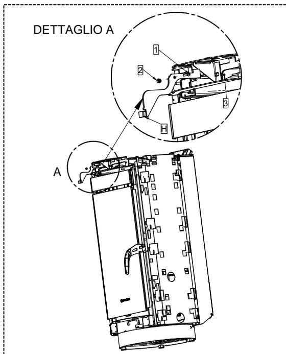
1 - Fixer le support (H) au trou (3) à travers la vis (1) et l'écrou (2).
