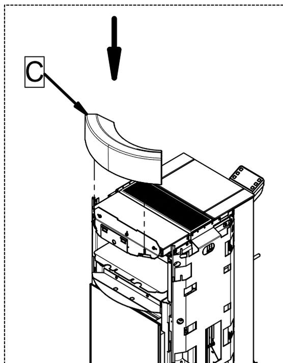
4 - Insérer la faïence supérieure (C) dans les dents appropriées. Déformer légèrement les dents pour que la faïence soit bien fixée au corps.
