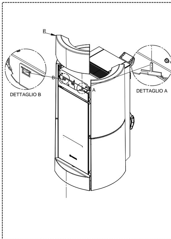
11 - Insérer la faïence supérieure (F) dans les dents appropriées. Déformer légèrement les dents pour que la faïence soit bien fixée au corps.
