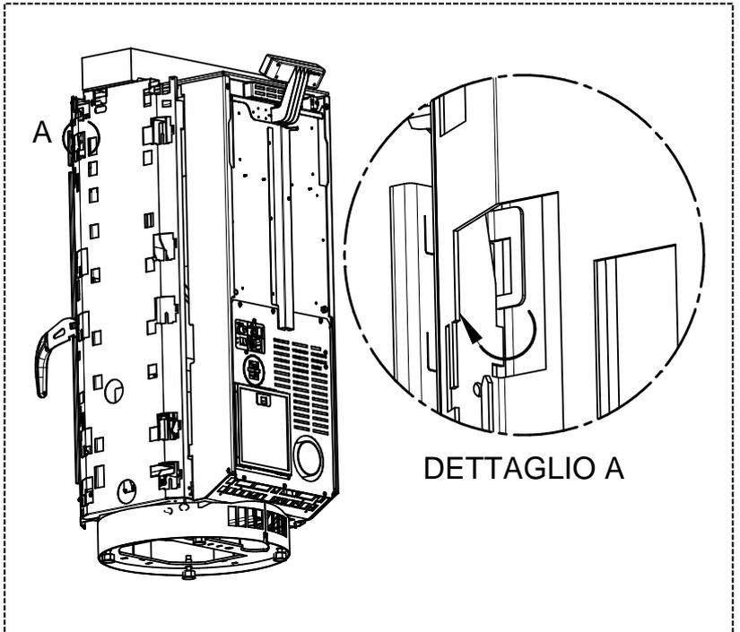
5 - Monter les quatre profils de compensation (I-L-M-N) en insérant les crochets de ceux-ci dans les rainures situées sur le corps de l'appareil. Dans certains cas, il est nécessaire de casser le dernier crochet situé à la base du profil supérieur.
