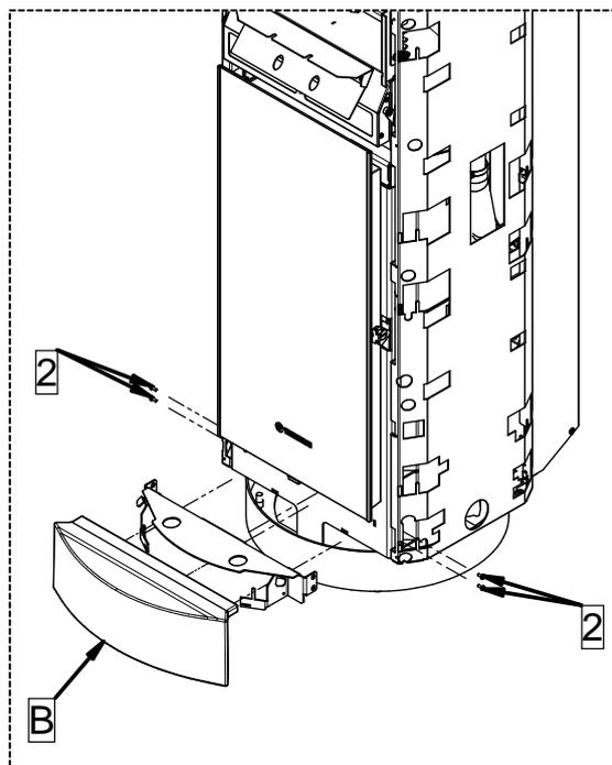
2 - Dévisser les 4 vis (2) et retirer le support de la faïence. Insérer la faïence inférieure (B) dans le support qui vient d'être enlevé. A la fin, fixer le support avec la faïence à l'aide des 4 vis (2) qui viennent d'être retirées.
