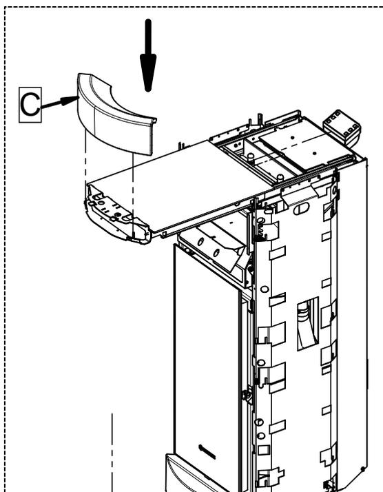
3 – Extraire le plateau et insérer la faïence supérieure (C) dans les dents appropriées. Déformer légèrement les dents pour que la faïence soit bien fixée au corps.
