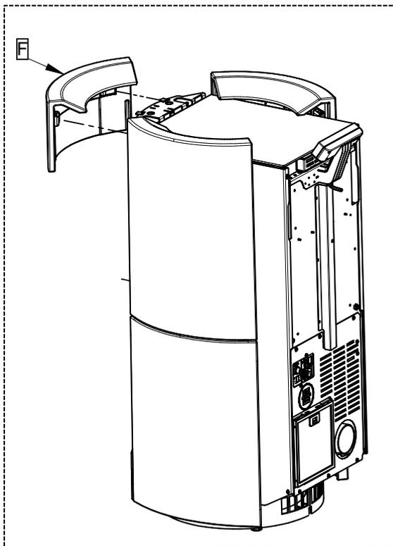
10 - Insérer la faïence supérieure (F) dans les dents appropriées. Déformer légèrement les dents pour que la faïence soit bien fixée au corps.
