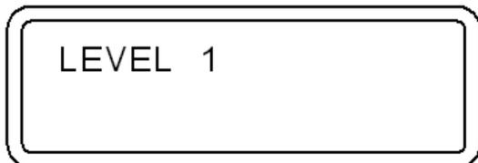
2) Pour modifier le niveau de fonctionnement, maintenir une **Touche de Défilement** appuyée et en même temps appuyer sur l'autre **touche de Défilement**.
