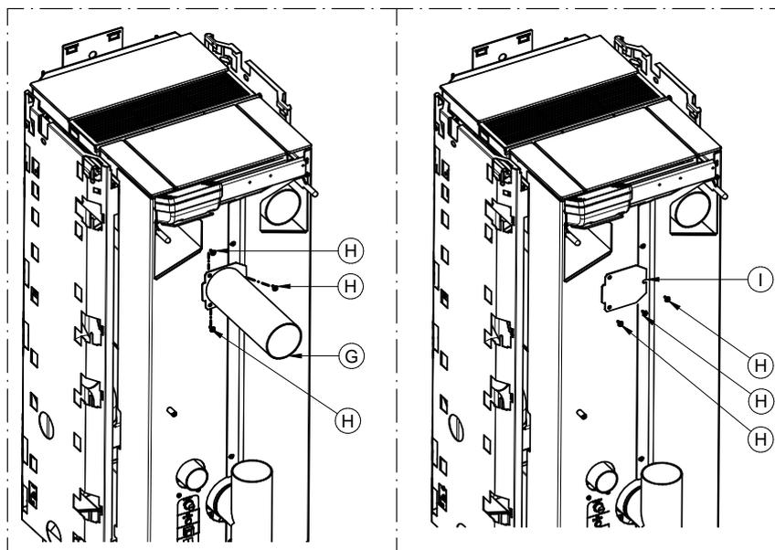
Si des tuyaux de longueur différente sont utilisés, il est conseillé d'insérer des registres pour ajuster le débit d'air avec fermeture partielle. Sinon, la canalisation la plus courte peut recevoir beaucoup plus d'air au détriment de la canalisation la plus longue.
