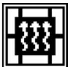
Affiche l'exclusion de ventilation, c'est-à-dire que le ventilateur d'air ambiant est désactivé. Cependant, si le corps du poêle monte en température, l'activation du ventilateur sera forcée et la puissance de ventilation augmentera à mesure que la température augmente, ce qui est visible par l'allumage des barres autour du symbole. Une fois que la température est tombée en dessous d'un certain seuil, le ventilateur d'air ambiant se désactive automatiquement.
